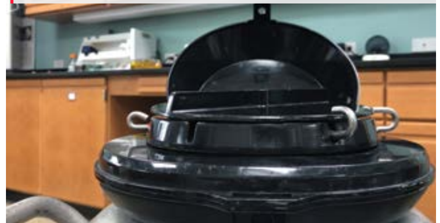
Colocação adequada da tampa do tanque de nitrogênio (completamente fechada)
